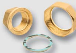
Art. TM 1557SET šroubení pro připojení čerpadla s vnitřním závitem ISO 228 (sada - 2x matka, 2x nipl, 2x těsnění)
